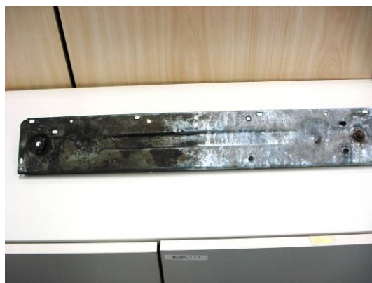
Suporte dos rodízios antes e após a oxidação
