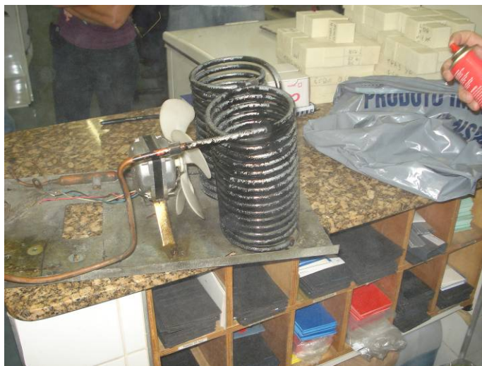
Aplicação feita na serpentina do condensador
