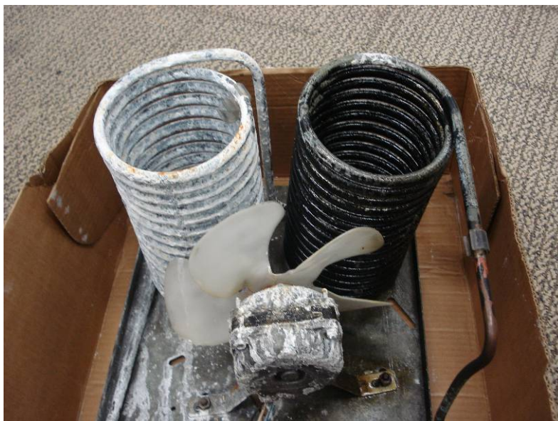
Serpentina do condensador após o teste
