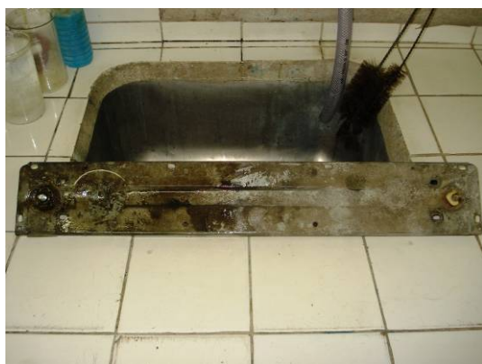
Suporte dos rodízios antes e após a oxidação
